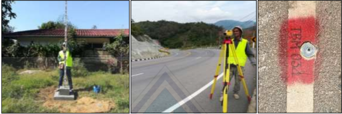
รูปที่ 4 การปฏิบัติงานการสำรวจค่าระดับ ด้วยวิธีการทำระดับแบบไป-กลับ (Double Run)
