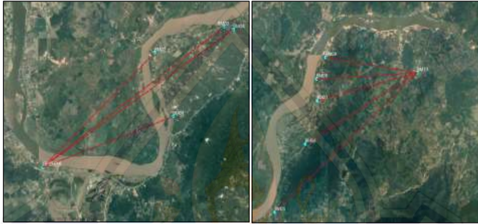
รูปที่ 7 โครงข่ายการรังวัดจากจุด GPS3658 และ BM10
