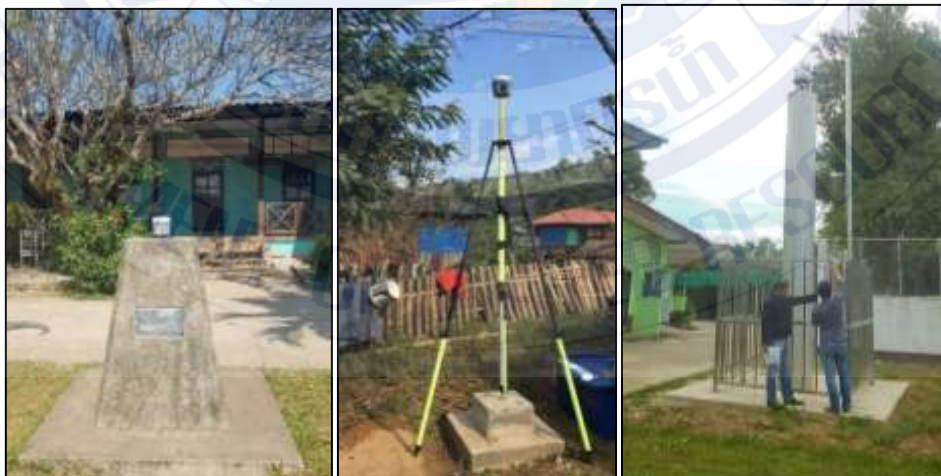
รูปที่ 6 การรังวัดหาค่าพิกัดของ Master Point ได้แก่ GPS3658 (ซ้าย) BM10 (กลาง) และ CORS CHKG (ขวา)
