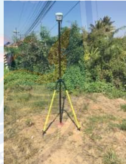
รูปที่ 4-8 การรังวัดหาค่าพิกัดด้วยเครื่องรับสัญญาณดาวเทียม GNSS (RTK)
