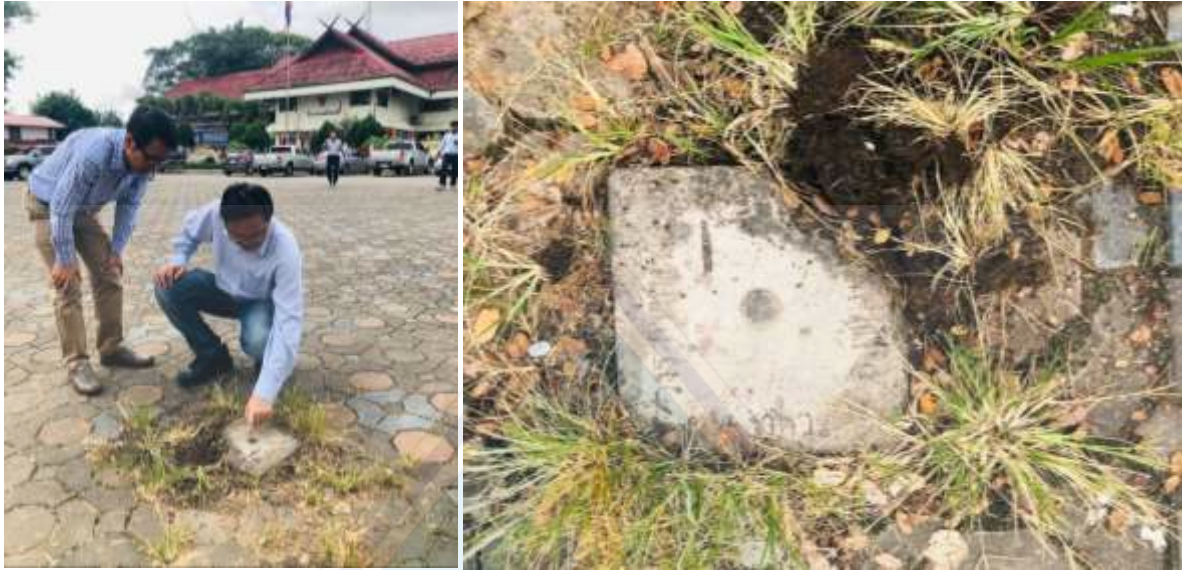
รูปที่ 2-2 หมุดหลักฐานทางดิ่ง กรมแผนที่ทหารบริเวณหน้าที่ว่าการอำเภอเชียงแสน
