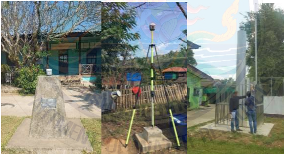
รูปที่ 4-2 การรังวัดหาค่าพิกัดของ Master Point ได้แก่ GPS3658 (ซ้าย) BM10 (กลาง) และ CORS CHKG (ขวา)
