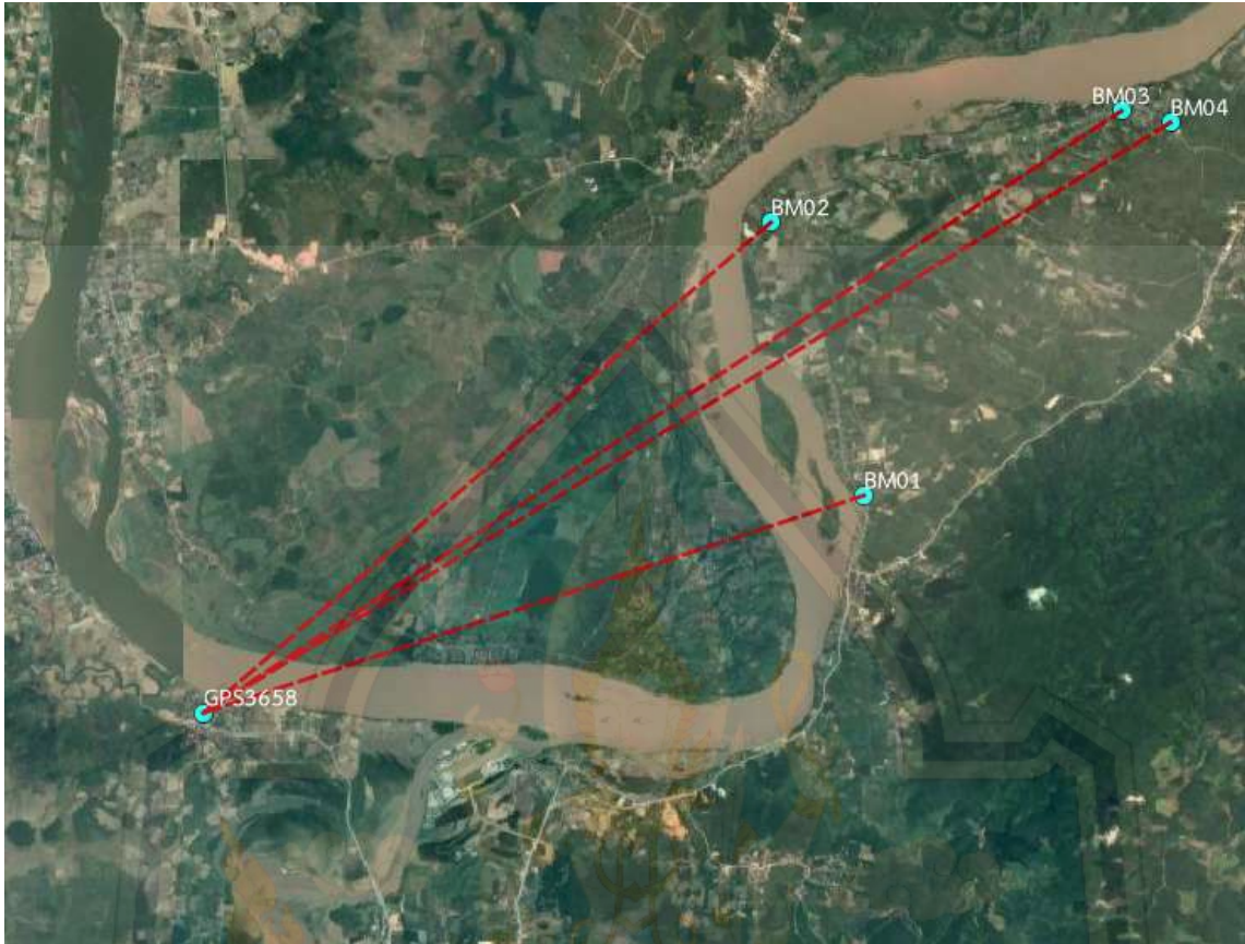
รูปที่ 4-3 โครงข่ายการรังวัดจากจุด GPS3658
