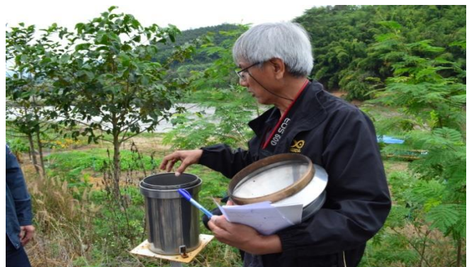
อธิบายการทำงานของเครื่องมือวัดน้ำฝน
